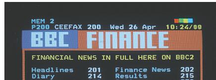
Eine Videotextseite mit dem farbigen Balken oben rechts zeigt an, dass es sich um eine Fasttextseite handelt.
